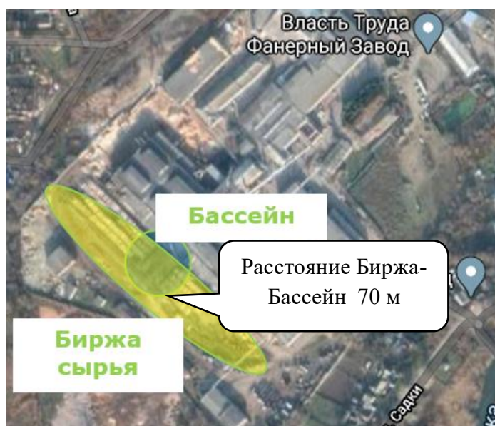
Рис.17 Схема размещения сырья при производстве ламинированной фанеры ПОСЛЕ улучшений
