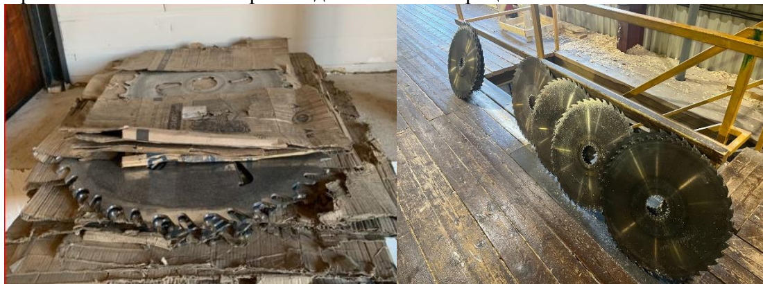
Рис. 7. Иллюстрация примера способа хранения и содержания дисковых пил на участке лесопиления ДО улучшений.
