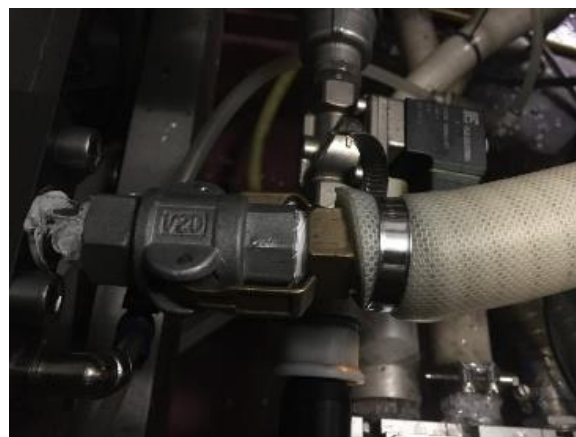
Рис. 11. Пример подсоединения шланга газации к спаянной плите быстросъемным соединением.
