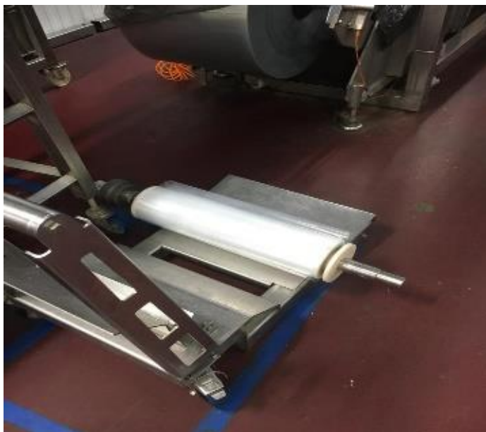
Рис. 12. Тележка с пленкой на втором валу, в ожидании выполнения предстоящей переналадки.
