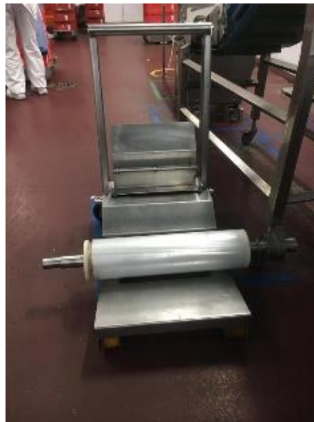
Рис. 12. Тележка с пленкой на втором валу, в ожидании выполнения предстоящей переналадки.
