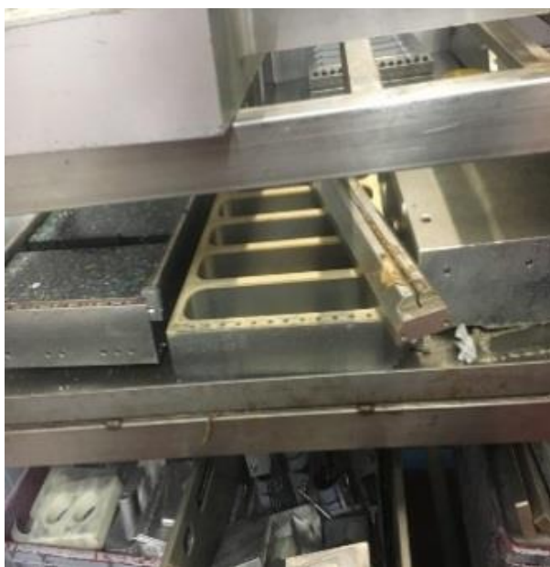
Рис. 7. Пример размещения оснастки и инструмента для переналадки за пределами участка.
