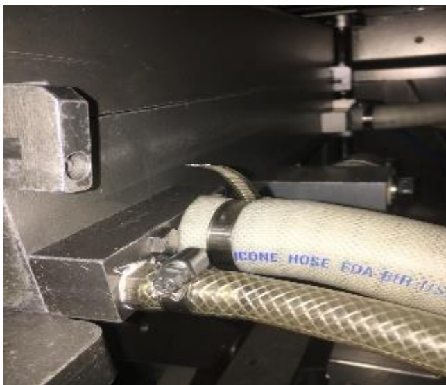
Рис. 6. Способ крепления вакуумных шлангов и трубок к спаечной плите и верхним кожухам.
