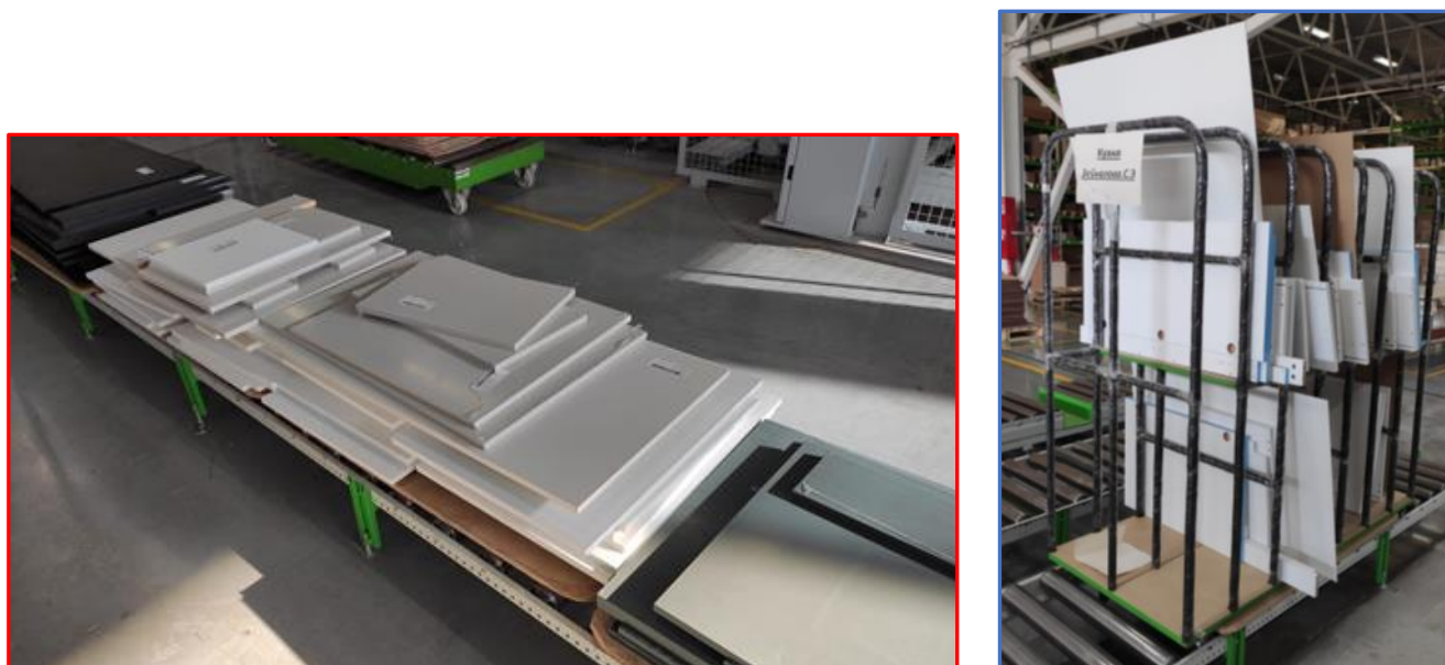
Рисунок 11. Иллюстрация способа передачи деталей модулей навалом (слева) и при использовании наборной тележки (справа ).
