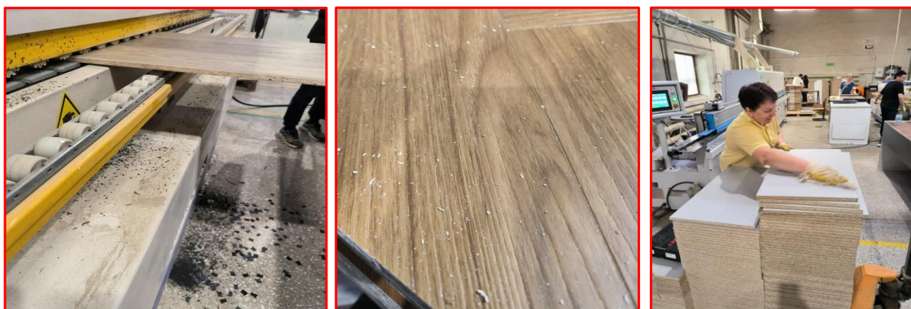
Рисунок 14. Иллюстрация процесса кромления (слева) и образующейся в процессе стружки (в центре), процесса очистки панелей от стружки (справа).
