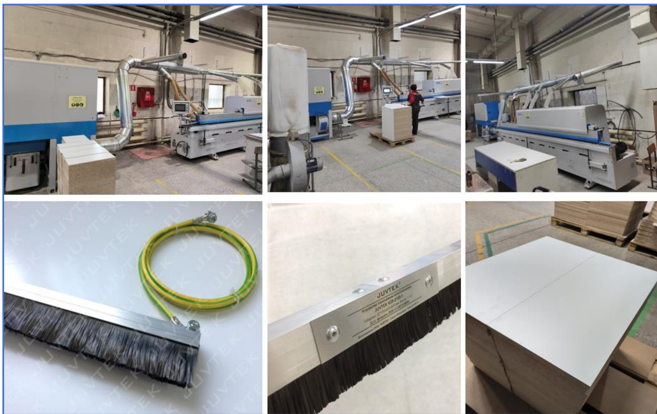
Рисунок 15. Станок кромления и установленные щетки для очистки панелей. Чистые панели ДСП после кромления.
