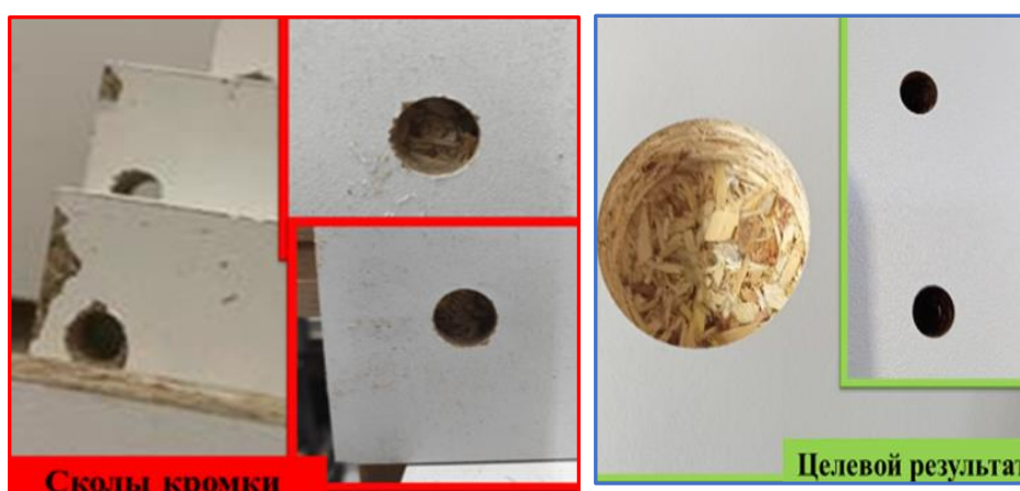
Рисунок 18. Примеры обработки деталей обычной фрезой (слева) и фрезой «Анти-скол» (справа).
