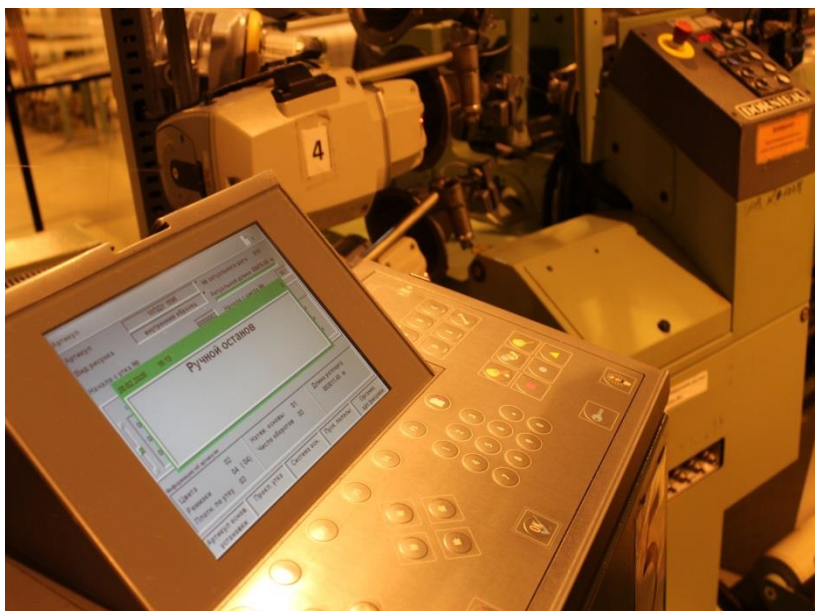
Принудительная остановка ткацкого станка вручную
