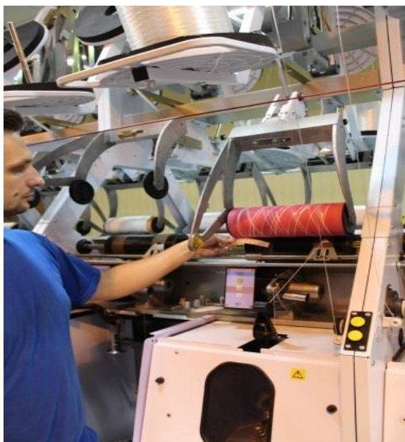
Заправка нитей в крутильный механизм машины
